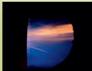
Zelfde brander met synthetische brandstof (HVO)
